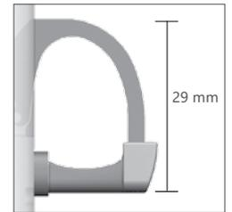
Mit einer Drehung des Schlüssels öffnen sich die Haken gleichzeitig!
